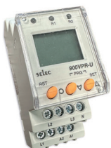
Spannungs- und Frequenzüberwachung: Die Überwachung der Spannungen aller 3 Phasen erfolgt, einschließlich des Abschaltens bei Phasenausfall, falscher Phasenfolge, Über- oder Unterspannung, Spannungsasymmetrie sowie Über- oder Unterfrequenz. Alle Werte sind vordefiniert und können angepasst werden.
